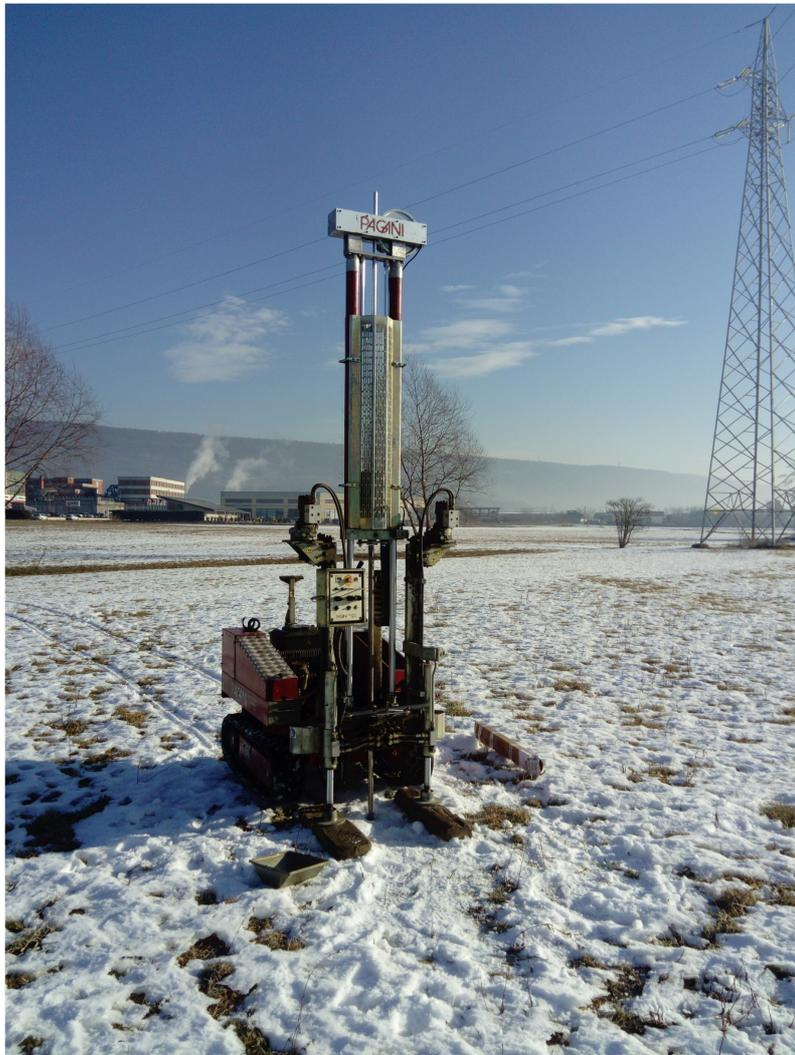
Fig 5: l'immagine riprende il penetrometro nel corso della prova P2.
