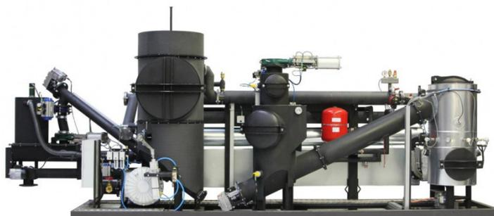
Il sistema di combustione parziale del pellet ha bisogno di un costante raffreddamento ed il calore così estratto viene utilizzato per la produzione di acqua calda in generazione distribuita attraverso la soluzione del micro-teleriscaldamento che servirà ad alimentare l'edificio esistente sull'area AR5.
